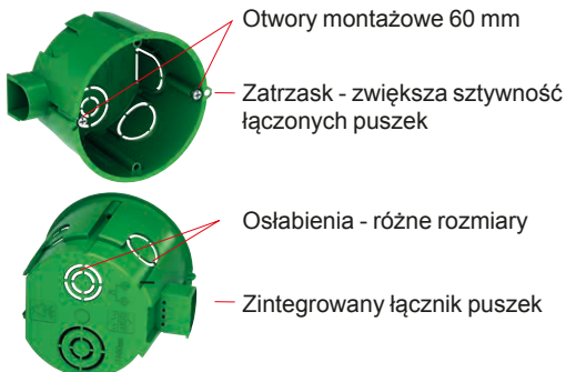
Połączenie puszek o różnych głębokościach. Zintegrowany łącznik zapewnia właściwą pozycję
